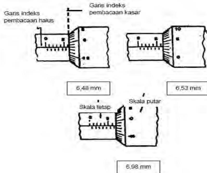
**Gambar 42. Pembacaan skala pada mikrometer**
