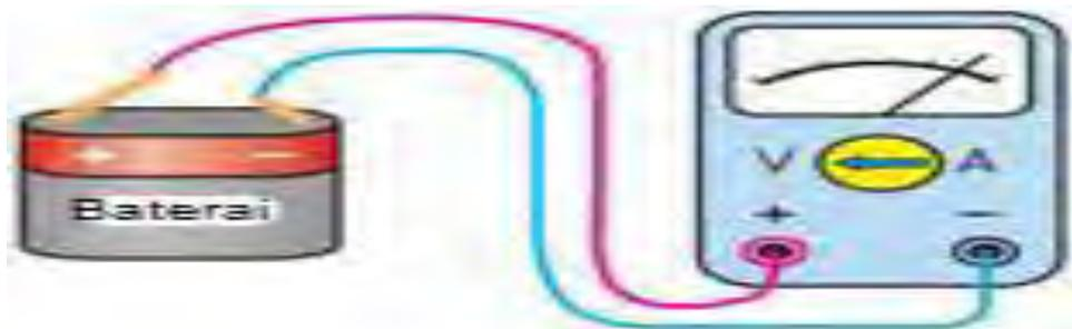
**Gambar 52. Rangkaian menggunakan Voltmeter**
