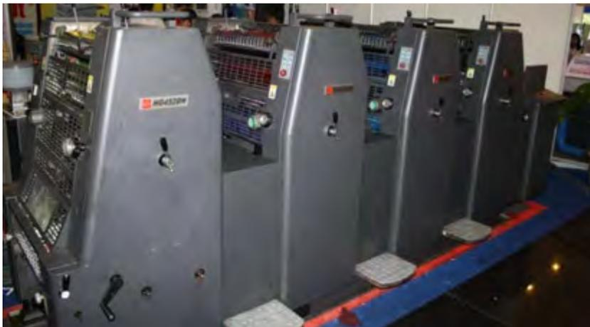
Gambar 6. Mesin cetak sheet 4 (empat) warna
