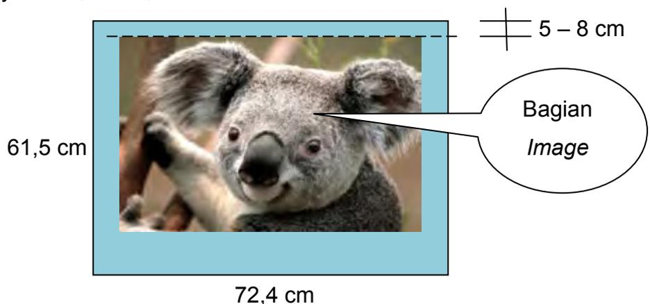
Gambar 1. Ukuran pelat cetak mesin cetak offset oliver 72
