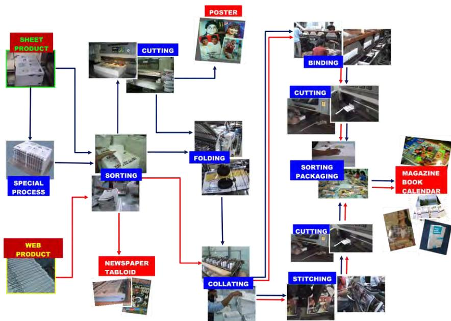
Gambar 3. Alur Proses Pekerjaan Bidang Purna Cetak
