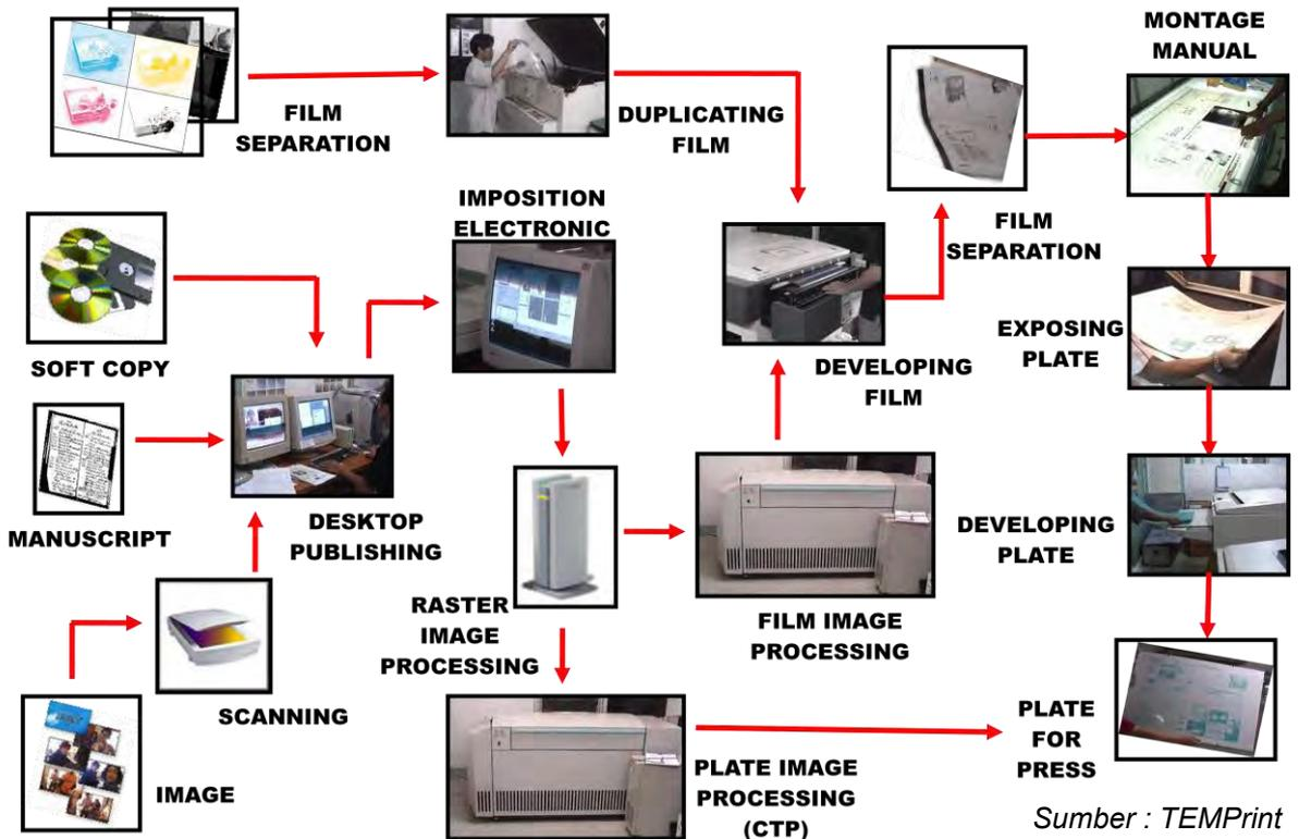
Gambar 1. Alur Proses Pekerjaan Bidang Pra Cetak
