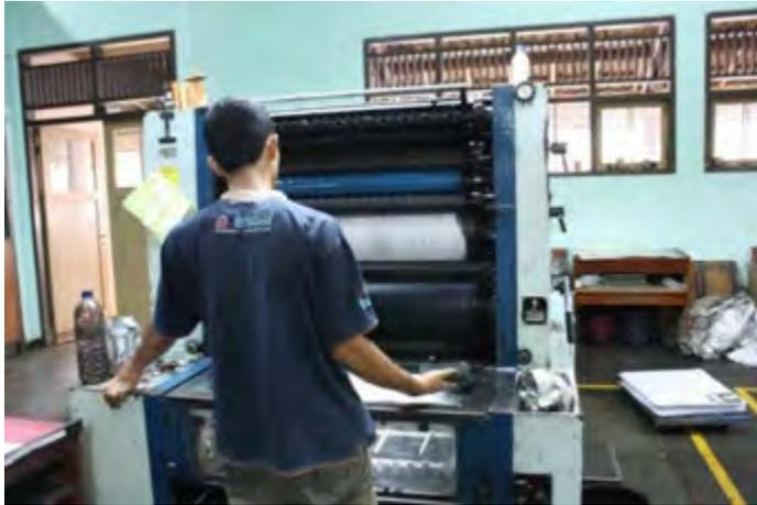
Gambar 5. Mesin cetak sheet Oliver 72 1 (satu) warna
