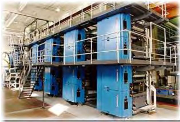
Gambar 8. Mesin cetak web 4 (empat) warna
