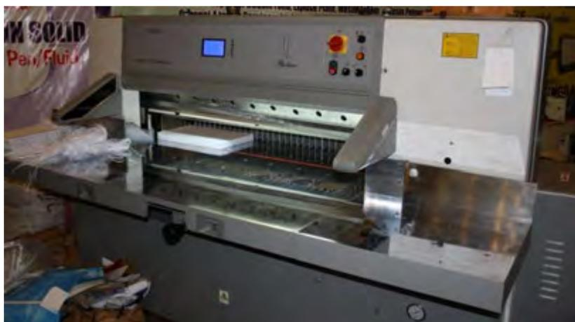
Gambar 7. Mesin potong 1 (satu) sisi
