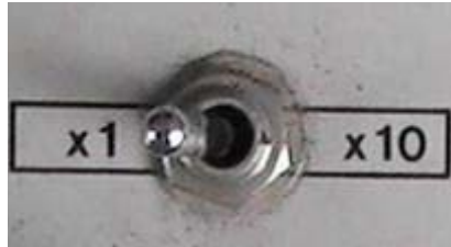
Gambar 3 – 26 Saklar D Q pada posisi x 1
