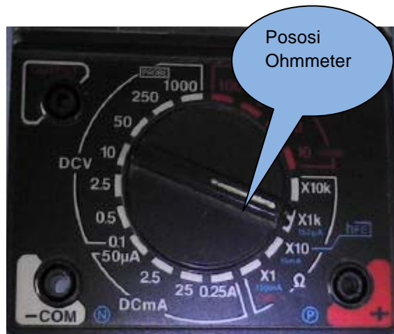
Gambar 2-79. Knob selektor posisi ohmmeter
