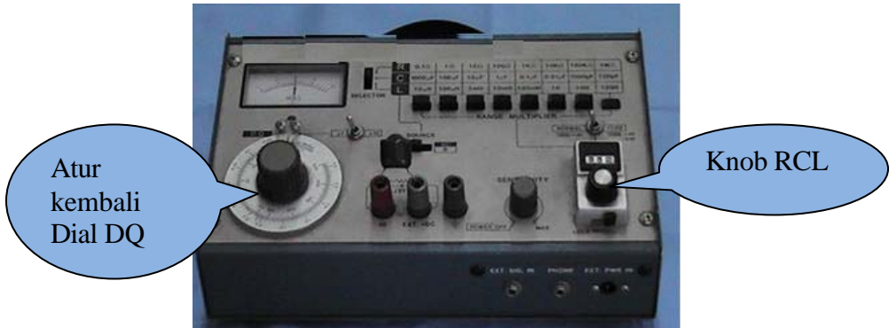
Gambar 3 – 33 Mengatur knob RCL dan dial D Q
