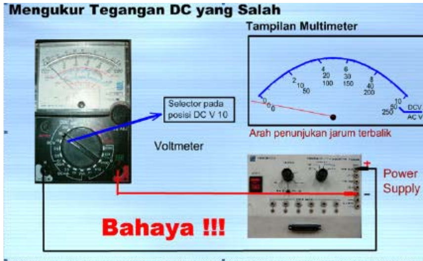
Gambar 2-47. Pengawatan pengukuran tegangan DC salah
