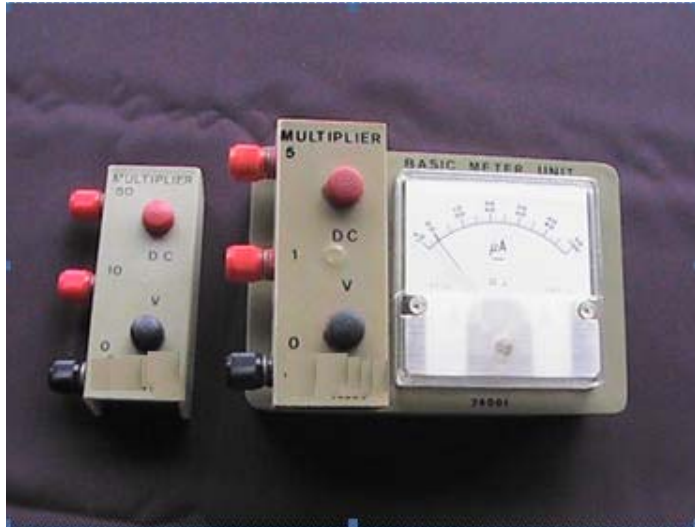
Gambar 2-17. Voltmeter dengan basic meter unit dan multiplier
