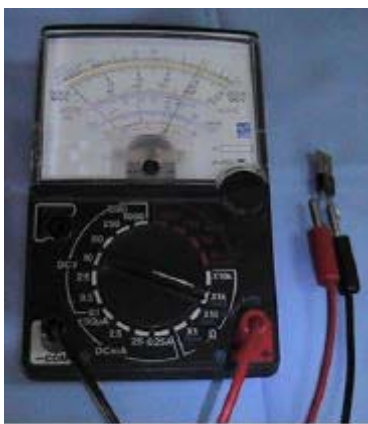
Gambar 2-86. Gate dilepaskan posisi jarum tetap nol
