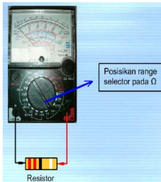
Gambar 2-61. Penempatan resistor pada pengukuran ohm
