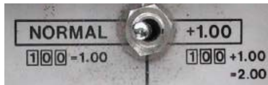
Gambar 3 – 27 Saklar normal +1,00 pada posisi normal
