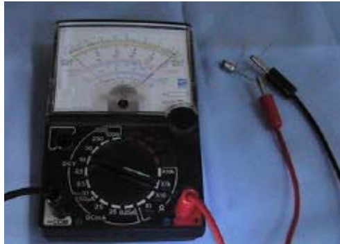
Gambar 2-81. Pengetesan transistor NPN emitor negatif meter nunjuk nol
