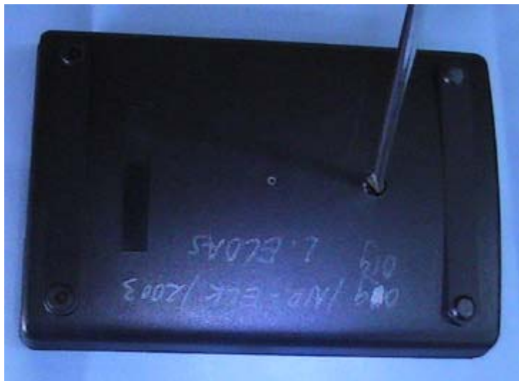
Gambar 2 - 88. Pelepasan sekrup pengunci sekering
