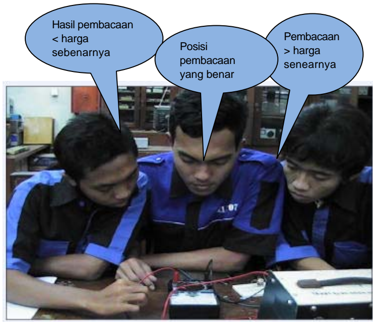
Gambar 1-3 Posisi pembacaan meter
