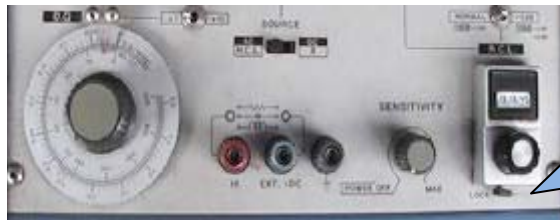
Gambar 3 – 21 Pengaturan indikator meter nol
