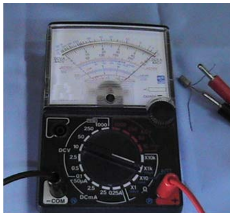
Gambar 2-82. Pengetesan transistor NPN kolektor negatif meter nunjuk nol
