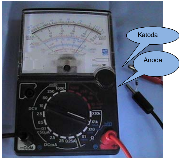
Gambar 2-77. Pengetesan dioda bias maju
