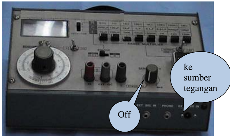
Gambar 3 – 43 Hubungan ke sumber tegangan luar
