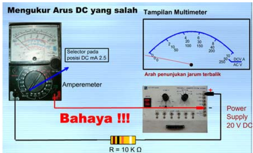
Gambar 2-56. Rangkaian pengukuran arus DC yang salah
