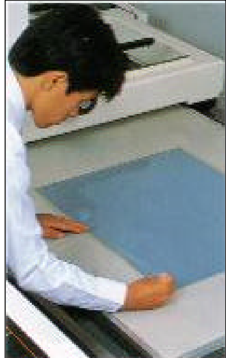
Gbr. Memasang plate pada step and repeat
