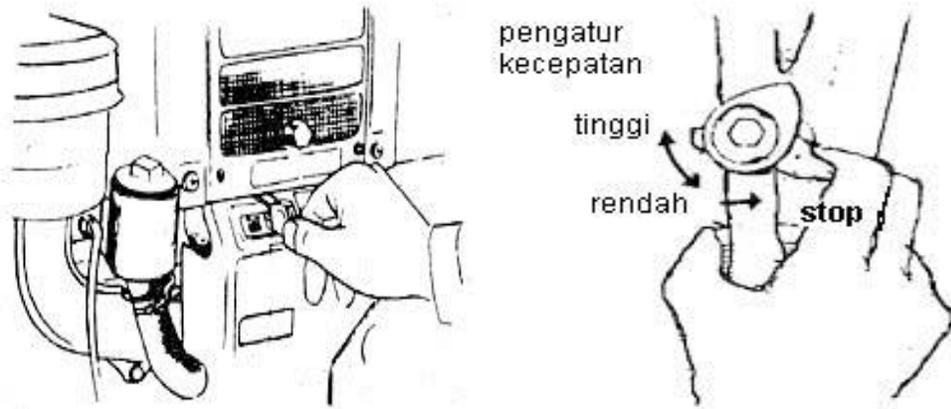
**Gambar 51: Tuas regulator motor penggerak dan tuas gas.**
