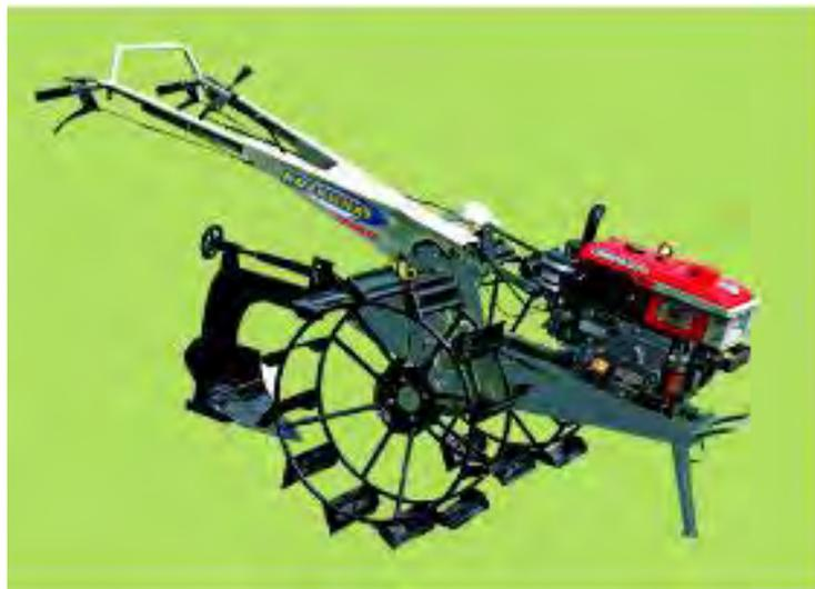
**Gambar 34: Traktor roda dua dengan roda sangkar**
