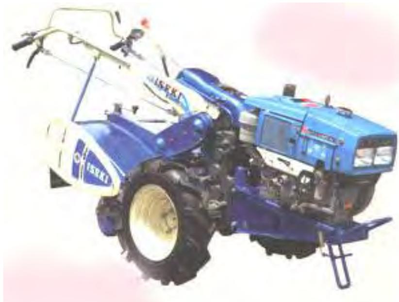
**Gambar 33: Traktor dengan roda ban**
