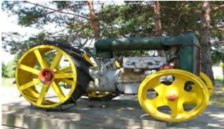
**Gambar 3: Contoh bentuk traktor tanpa kerangka landasan**
