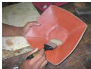
Gambar 2.177. Finishing menggunakan kuas
