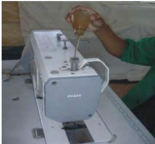
Gambar 2.98. Pemberian minyak pada mesin
