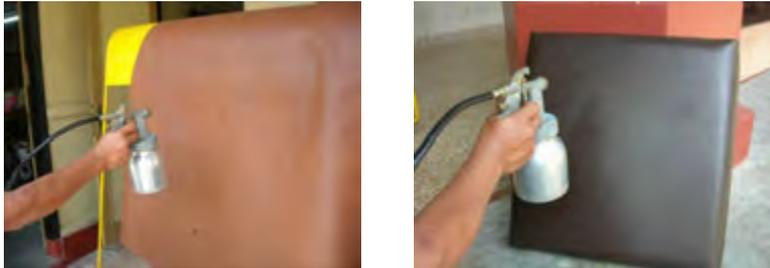
Gambar 2.174. Finishing dengan kompresor/spray gun
