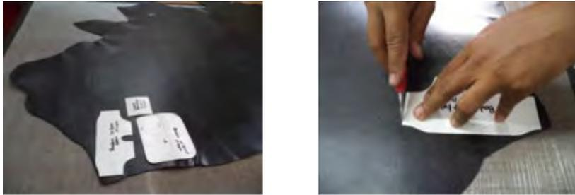
Gambar 4.2. Pemotongan bahan kulit
