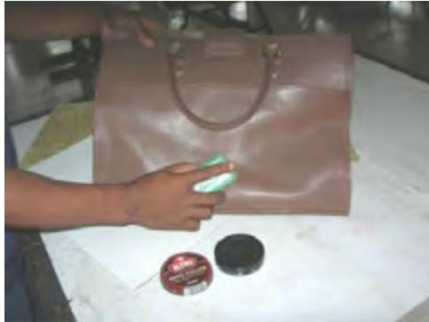
Gambar 2.179. Finishing menggunakan semir dan bensin
