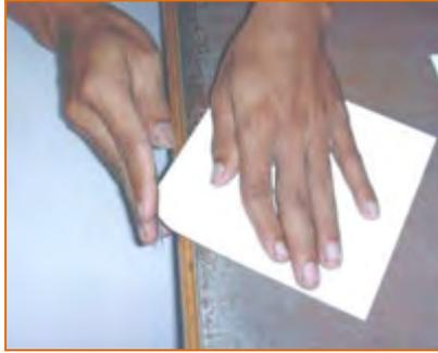
Gambar 2.14. Cara menghaluskan bagian sudut dengan amplas
