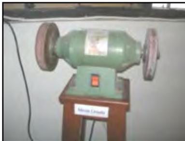
Gambar 5.7. Mesin amplas kulit
