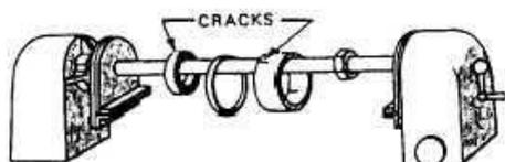
Gambar 5.5 Menggunakan konduktor pusat untuk circularly magnet ringlike bagian.
