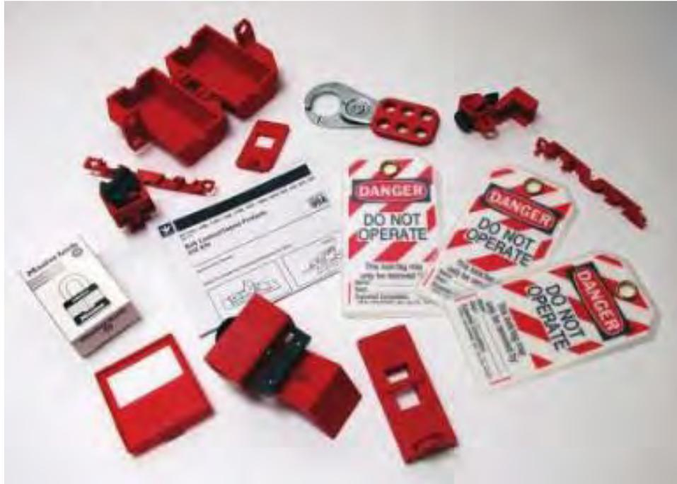
Gambar 1.23 Berbagai bentuk Piranti Untuk keperluan Lock out dan Tag out.
