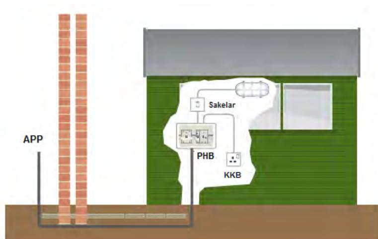
Gambar 4.2 Tipikal Pembagian Beban Listrik pada suatu jala-jala tegangan 220/380V
