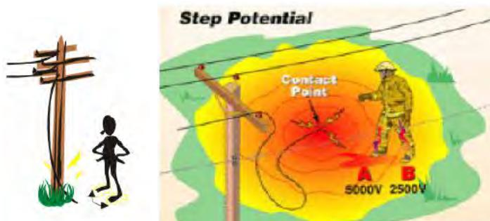
**Gambar 1.6 Tegangan Langkah**
