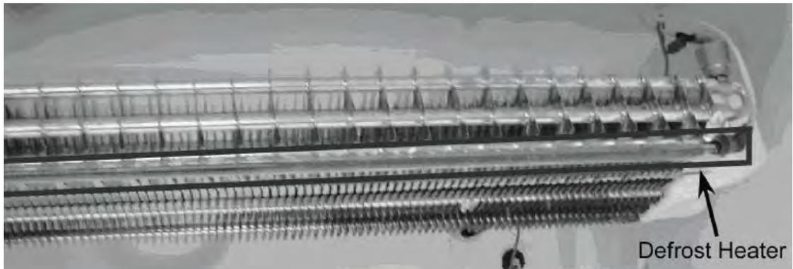
**Gambar 2.4** Tipikal Defrost Heater yang terpasang di Evaporator
