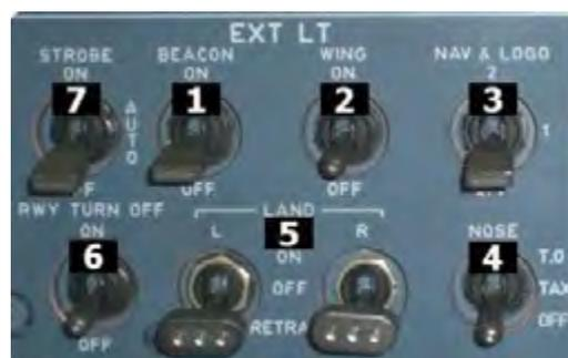
Gambar 2.2 Selektor Kontrol Lampu Pendaratan.
