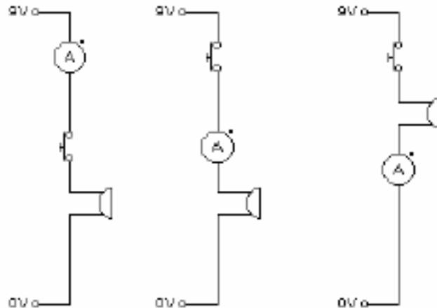
Gambar 31. Pengukuran Arus pada Rangkaian
