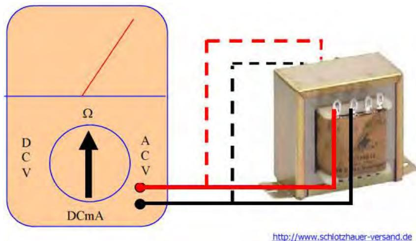
Gambar 24. Mengukur Transformator
