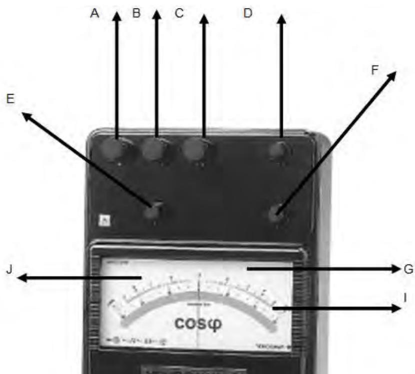
Gambar 52. Konfigurasi Cos  $\varphi$  Meter
