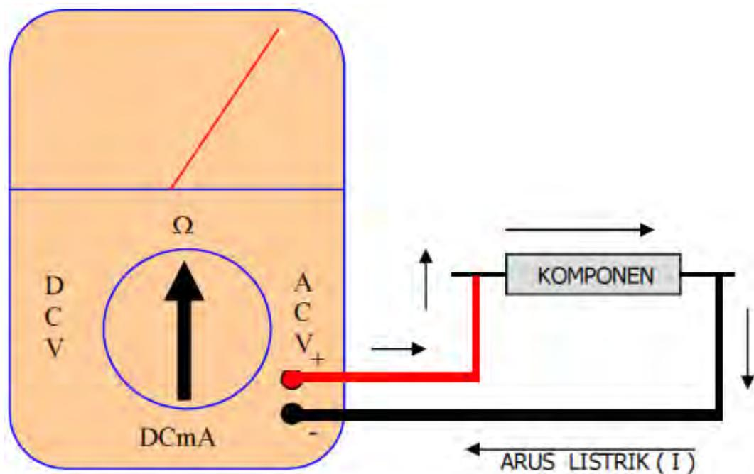
Gambar 27. Aliran Arus Listrik dari Multimeter ke Komponen
