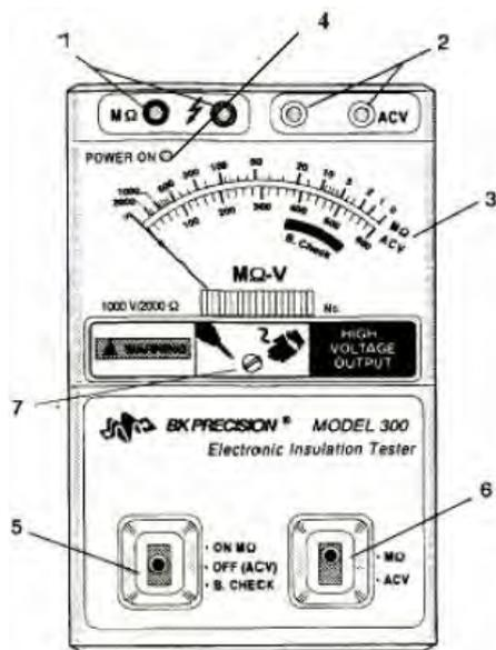
Gambar 42. Kontrol dan Indikator *Insulation Tester*
