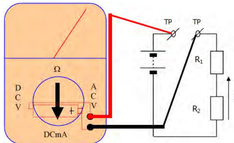
Gambar 30. Pengukuran Arus pada Rangkaian
