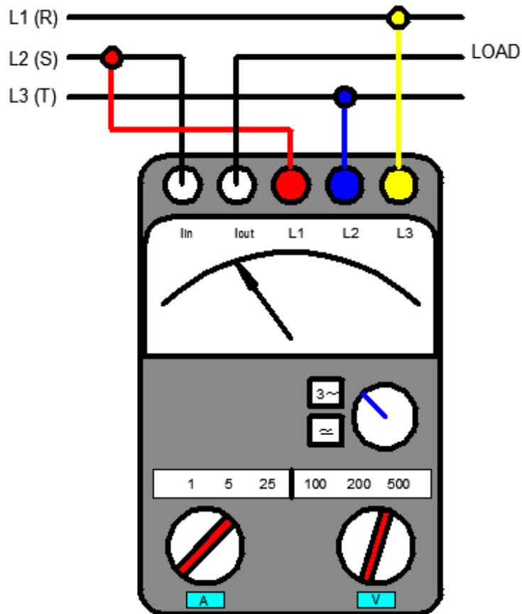
Gambar 50. Bagan hubungan wattmeter untuk pengukuran daya tiga phase
