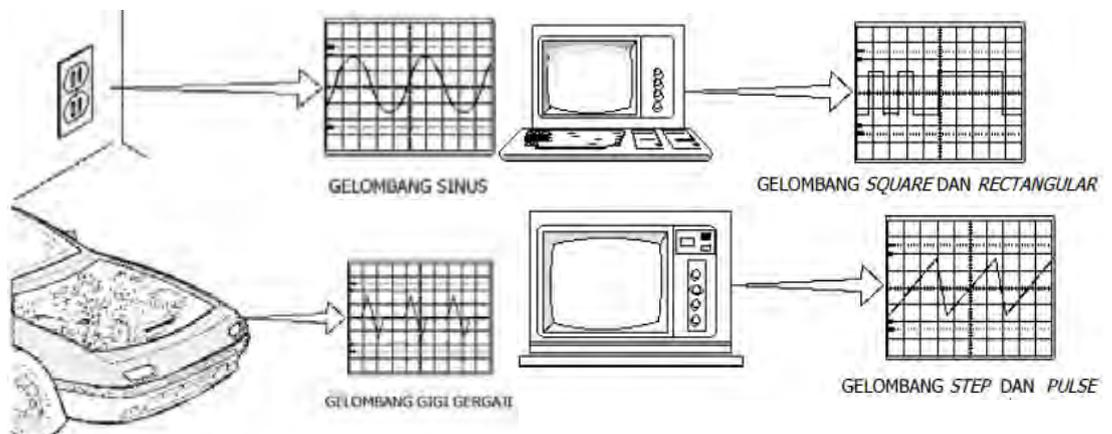
Gambar 37. Bentuk Gelombang dari Input Luar (Jaringan Listrik, TV, dan Mobil)
