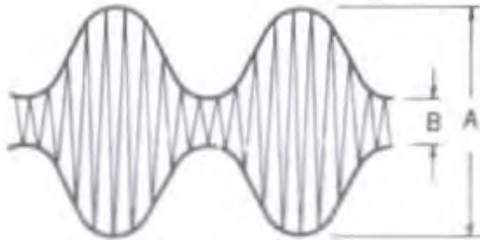
Gambar 38. Amplitudo Modulasi
