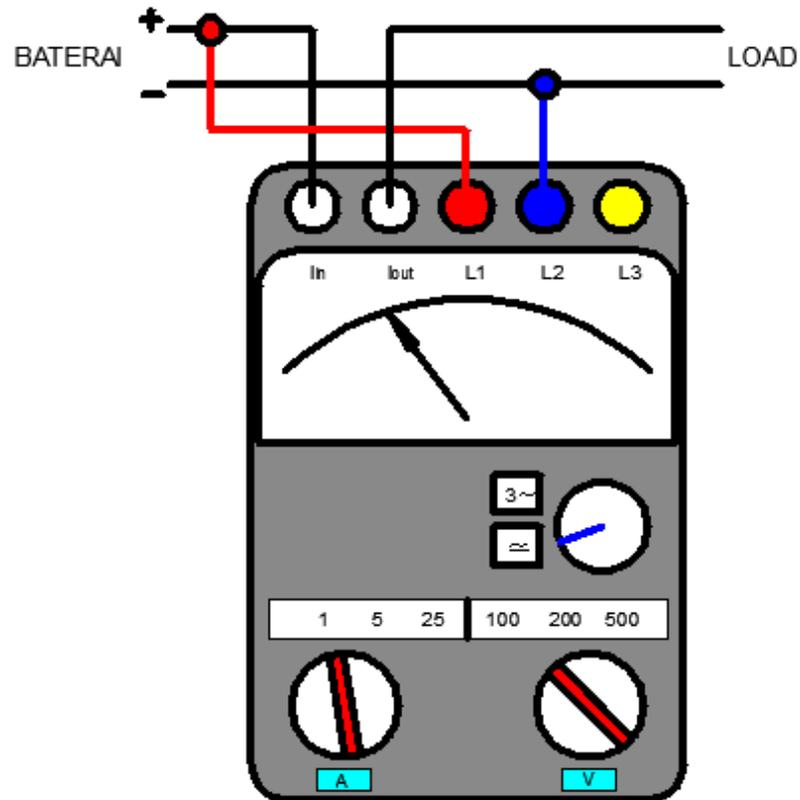
Gambar 48. Bagan hubungan wattmeter untuk pengukuran daya DC
