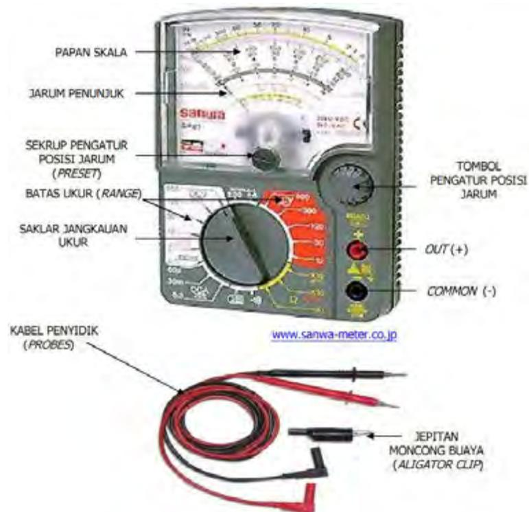
Gambar 3. Konfigurasi Multimeter
