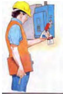
Gambar 4.41 Tanda pekerjaan selesai
