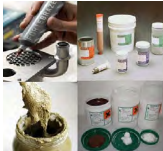
Gambar 2. 120 Fluks berbentuk pasta dan serbuk
