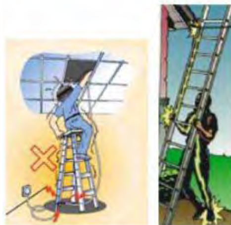
Gambar 4.35 Penggunaan tangga di daerah instalasi listrik
