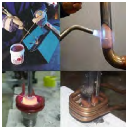
Gambar 2. 134 Penyambungan patri dengan torch dan pemanas coil
