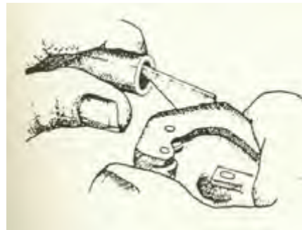
Gambar 3.50 Cara Membersihkan Ujung Pipa
