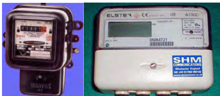
Gambar 4.57 Kwh meter satu fasa analog dan digital
