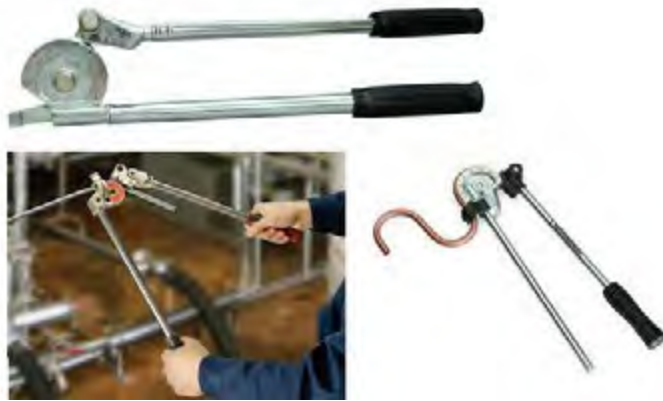
Gambar 3.53 Membengkok pipa dengan lever bender
