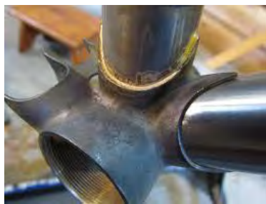
Gambar 2.130 Pembuatan kampuh diupayakan memperbesar bidang patri
