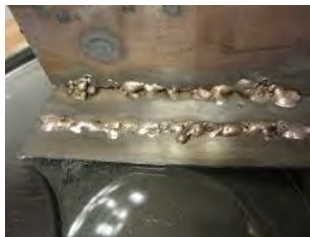
Gambar 2.131 Benda kerja kotor menghasilkan patrian yang tidak beraturan
