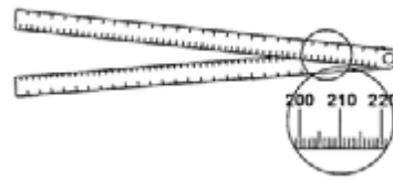
Mistar Lipat Untuk mengukur dan memindahkan sudut
