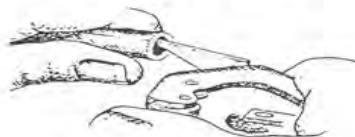
Cara membersihkan ujung pipa
