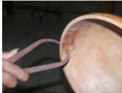
Gambar 4-12. Mengukur ketebalan benda kerja.
