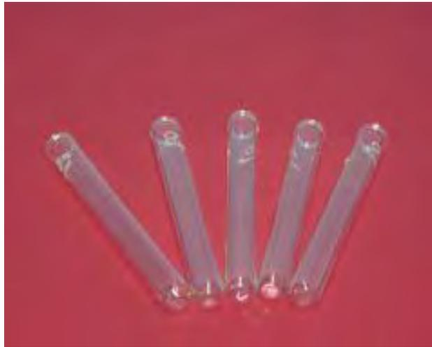
**Gambar 15. Tabung reaksi (test tube)**
