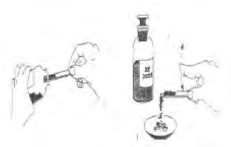
**Gambar 44. Teknik penuangan bahan kimia padat menggunakan spatula atau sendok**
