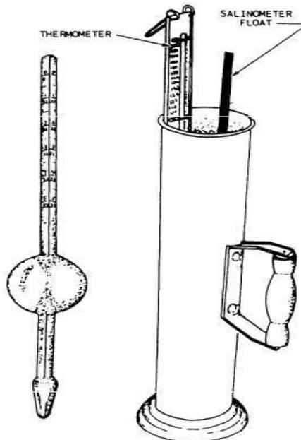
**Gambar 30. Salinometer**
