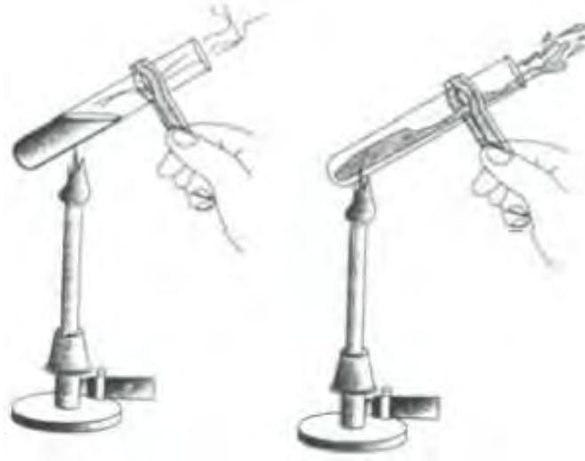
**Gambar 48. Proses pemanasan bahan dalam tabung reaksi**
