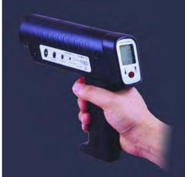
Gambar 28. Termometer Inframerah atau Non-kontak
