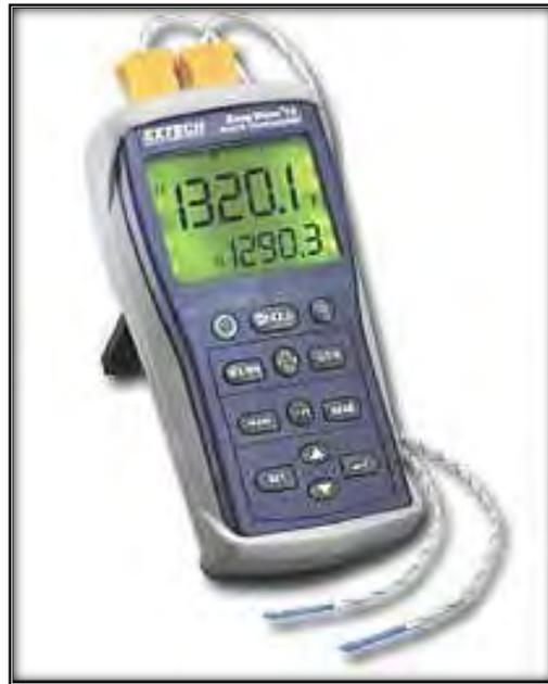
Gambar 27. Termometer digital (Termokopel)
