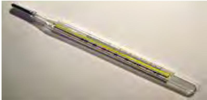
Gambar 26. *Termometer Bulb*
