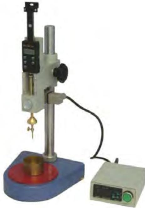
Digunakan untuk menentukan kekerasan dengan beban, waktu dan panas yang konstan. Penetrometer terdiri dari besi cor dasar dengan sekrup rata, ketelitian digital pengukuran kekerasan 0,01 mmp-
