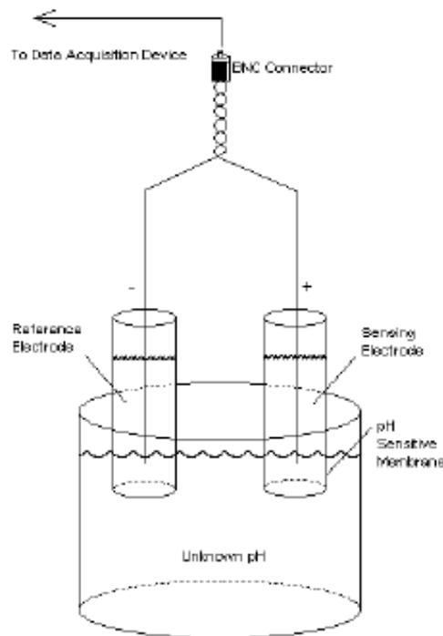
Gambar 31. Elektroda Potensiometrik
