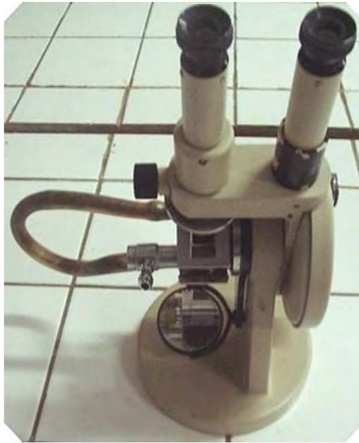
Gambar 21. Alat Penetapan Index Bias (Refraktometer)
