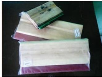
gambar 6 Rakel untuk meratakan warna
