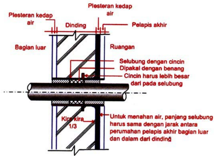
Gambar XIV-15, Plesteran Kedap Air Tanpa Penutup Bata
