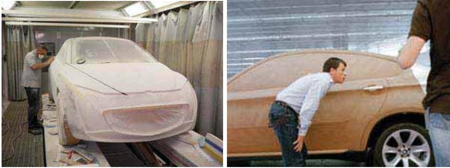
Gambar 1.14. Prototipe mobil
