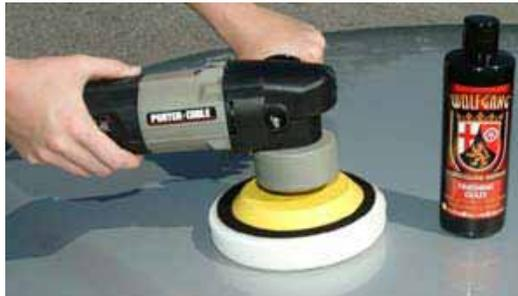
Gambar 1.26. Polishing menghilangkan goresan pada cat
