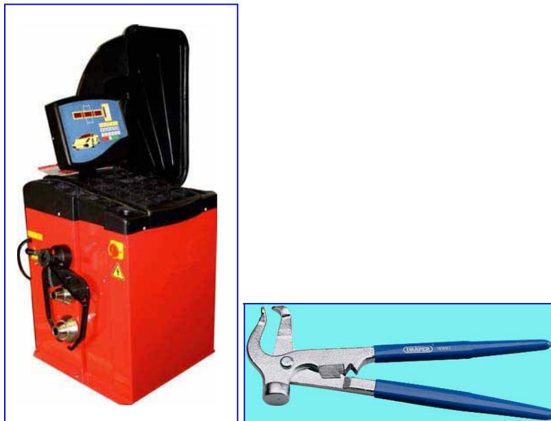
Gambar 4.20. *Balancer* Roda dan tang pengungkit
