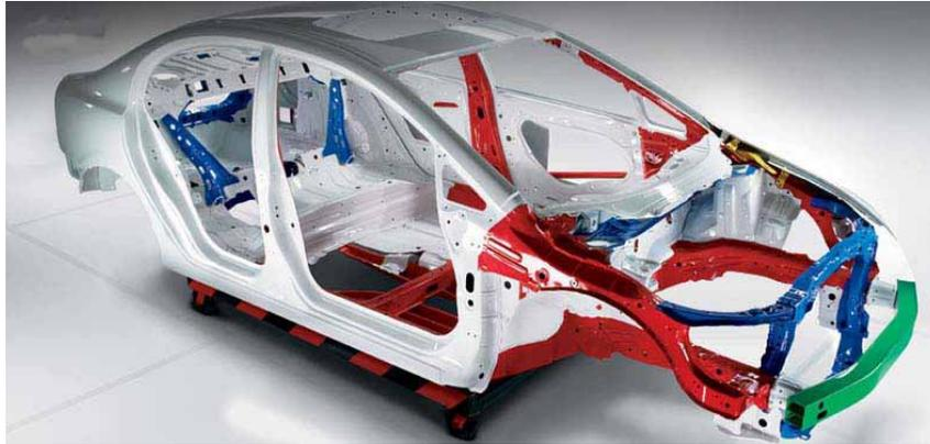
Gambar 1.6. Konstruksi Bodi Integral (*Monocoque Body*)
