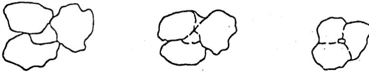
**Gambar 2.16. Perubahan bentuk kristal selama sintering**
