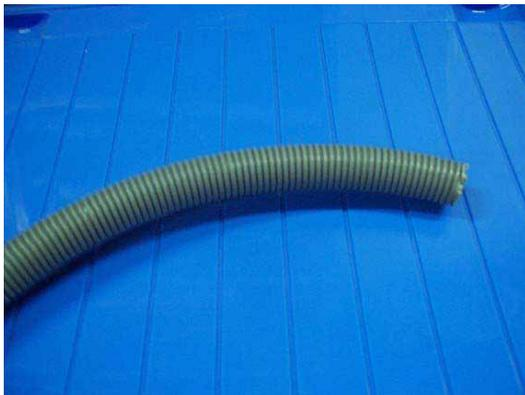
Pipa fleksibel dibuat dari potongan logam / PVC pendek yang disambung sedemikian rupa sehingga mudah diatur dan lentur. Pipa ini biasa digunakan sebagai pelindung kabel yang berasal dari dak standar ke APP, atau juga digunakan sebagai pelindung penghantar instalasi tenaga yang menggunakan motor listrik, misalnya mesin press, mesin bubut, mesin skraf, dan lain-lain.
