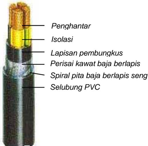
Kabel tanah thermoplastik berperisai seperti NYFGbY, biasanya digunakan apabila ada kemungkinan terjadi gangguan kabel secara mekanis, kabel NYFGbY intinya terdiri dari penghantar tembaga, dengan isolasi PVC, penggabungan dua atau lebih inti dilengkapi selubung atau pelindung yang terdiri dari karet dan perisai kawat baja bulat. Perisai dan pembungkus diikat dengan spiral pita baja, untuk menghindari korosi pada pita baja, maka kabel di selubungi pelindung PVC warna hitam.
