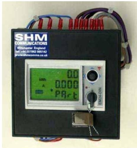
Gambar 2.15 Kwh meter tiga fasa analog dan digital
