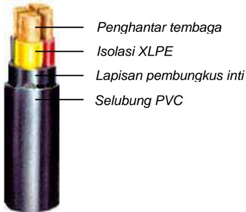
Kabel tanah thermoplastik tanpa perisai yang di pakai di PT. Pupuk Kujang ialah N2XY, kabel N2XY intinya terdiri dari penghantar tembaga, dengan isolasi XLPE, berpelindung bebat tembaga serta berselubung PVC dengan tegangan pengenal 0,6/1 kV (1,2 kV) yang dipasang sejajar pada suatu sistem fase tiga.
