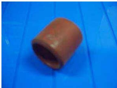
Pipa untuk instalasi listrik (khususnya union) pada bagian ujung pipa terdapat bagian yang tajam akibat bekas pemotongan dari pabrik maupun pada pelaksanaan pekerjaan. Agar tidak merusak kabel maka bagian yang tajam ini harus diratakan/ dihaluskan dan perlu waktu yang cukup lama. Untuk mengantisipasi masalah ini cukup dipasang tule pada bagian ujung pipa yang tajam tadi.
