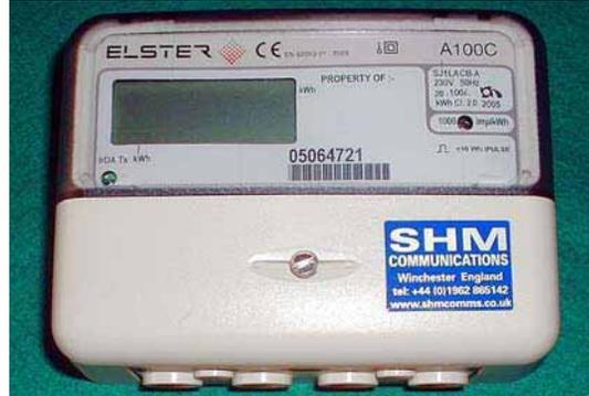
Gambar 2.14 Kwh meter satu fasa analog dan digital
